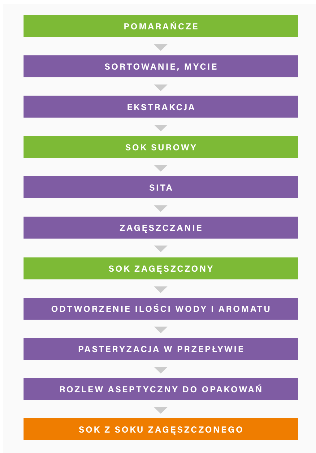
Ryc. 2. Schemat produkcji soku pomarańczowego odtworzonego z soku zagęszczonego
